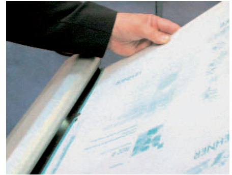
Die Druckplatten werden nacheinander in das Messgerät eingestellt.
